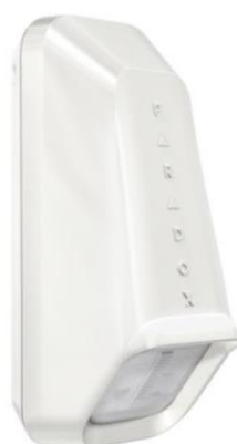
NV35M چشمی با سیم پرده ای قابلیت آنتی ماسک و پرتو IR فعال برای تشخیص اسپری مایعات و اشیا مسدود کننده تا ۳۰ سانتیمتر تشخیص و تفکیک زون تحریک شده
